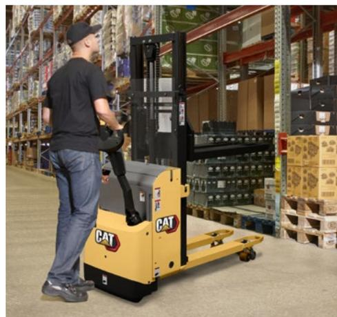
El manipulador de doble palet de conductor acompañante NPP16PD aumenta la productividad al transportar dos palets de forma simultánea (uno sobre otro). Es perfecto para la carga y descarga en rampas niveladoras, recogida y reposición y el transporte de cargas de distancia corta en almacenes, supermercados y zonas de producción.
