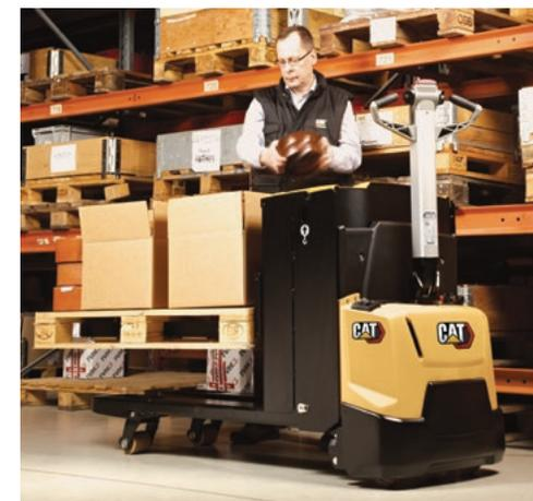
La NPP20N2E está equipada con horquillas de elevación (altura de 735 mm) que ofrecen una posición ergonómica para cargar y descargar artículos con un esfuerzo físico mínimo.
