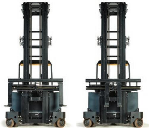
El posicionador de horquillas de alta calidad proporciona la amplitud de que se necesita para manejar una gran variedad de cargas.
