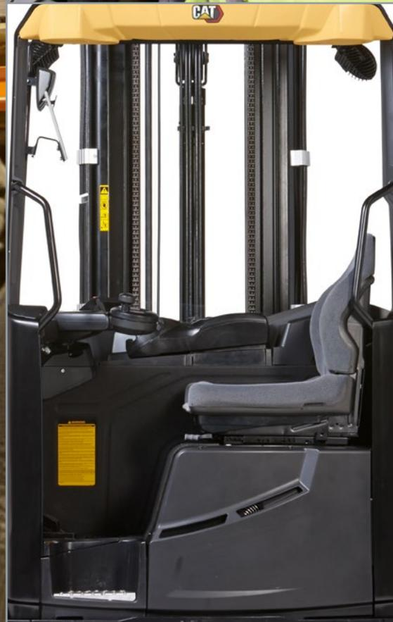
Visibilidad del operario muy despejada (izquierda y abajo), con cables y mangueras cuidadosamente colocados y los cilindros hidráulicos incorporados al perfil del mástil (izquierda).
