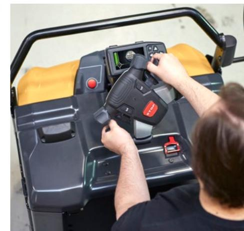
В этих мощных тягачах грузоподъемностью 3 и 5 тонн используются умные технологии, основанные на адаптивной системе управления Cat® (RDS). Усовершенствованное рулевое управление, интеллектуальная система управления на поворотах и автоматическая оптимизация тяги, ускорения и торможения способствуют плавному, точному, безопасному и уверенному вождению.
