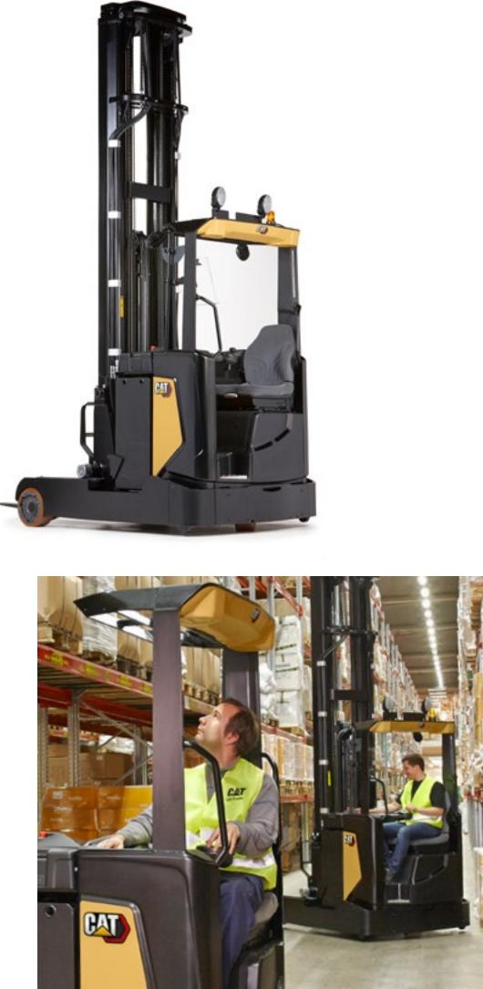
Cu cilindri hidraulici încorporați în profil, catargul poweRamic este mai puternic, mai îngust și asigură o vizibilitate mai bună decât construcțiile clasice. Toate mișcările stivuitorului și ansamblul catargului sunt controlate fin și precis grație sistemului RDS.
