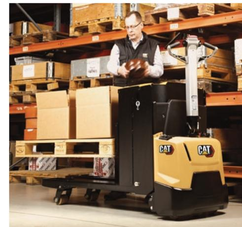
O NPP20N2E está equipado com garfos de elevação (735 mm de altura) que oferecem uma posição ergonómica para carga e descarga de artigos com o mínimo esforço físico.
