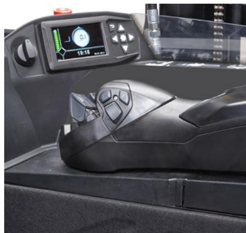
Os avançados controlos hidráulicos tácteis estão incorporados num apoio de braço ergonómico ajustável. A altura e o ângulo do volante podem ser ajustados e o condutor pode utilizar várias posições das mãos durante a condução. Um visor multifuncional com mostradores de cores vivas fornece informações úteis.
