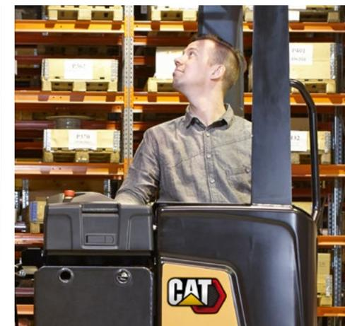
A velocidade de deslocação é controlada de forma suave e automática nas curvas ou quando os garfos são elevados, para evitar um comportamento inseguro. Outras medidas de segurança incluem desaceleração contínua da resposta da direção com aumento da velocidade de deslocação, para controlar as manobras com total segurança.
