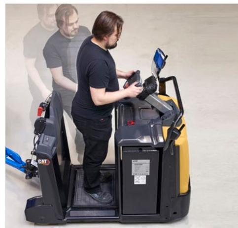
Uma operação a passo ao lado da máquina ("walk-beside"), proporcionando uma visão clara do atrelado é particularmente útil ao manobrar para acoplar ou desacoplar. Também permite movimentos curtos fáceis do empilhador. Numa posição de caminhada, a função "flying start" permite aos operadores iniciar a aceleração antes da subida para bordo.
