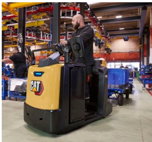
Estes potentes empilhadores de reboque de 3,0 t e heavy duty de 5,0 t de capacidade utilizam tecnologia inteligente baseada no Sistema de Acionamento Responsivo (RDS - Responsive Drive System) Cat®. Direção adaptativa, controlo inteligente de curva e otimização automática da tração, aceleração e travagem, asseguram uma condução suave, precisa, segura e aprazível.
