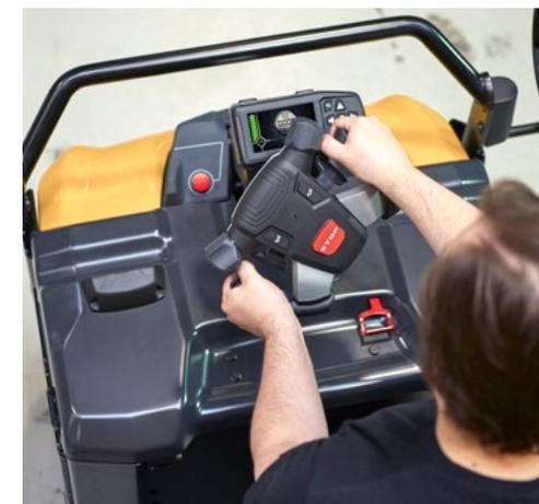
Controlos ergonomicamente concebidos, integrados no inovador volante da direção, são fáceis de alcançar pelo condutor, sem necessidade de soltar o volante. A unidade de direção com amortecimento de vibração pode ser facilmente operada com qualquer uma das mãos e é ajustável para a altura e ângulo perfeitos.
