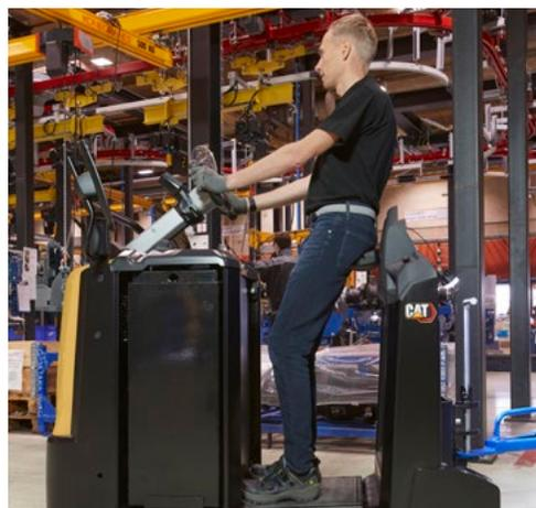
Proporcionando um elevado conforto, redução da fadiga e a máxima eficiência em termos de tempo, o espaçoso compartimento do operador tem uma altura de acesso baixa e proporciona acesso de entrada/saída e passagem desobstruído. Um piso de suspensão tripla com amortecimento de vibração e um encosto confortável acrescentam ainda mais requinte.
