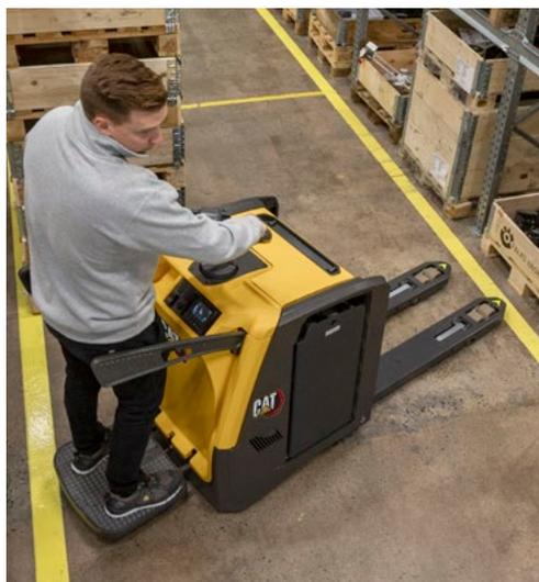
I modelli sono disponibili con pedane pieghevoli o fisse, portate di 2.0 o 2.5 tonnellate, e una scelta di telai di tre lunghezze. Possono anche essere predisposti per batterie agli ioni di litio oppure al piombo-acido. Le versioni a pedana pieghevole NPV20N3 ed NPV25N3 sono dotate di barre laterali di protezione alzabili/abbassabili.
