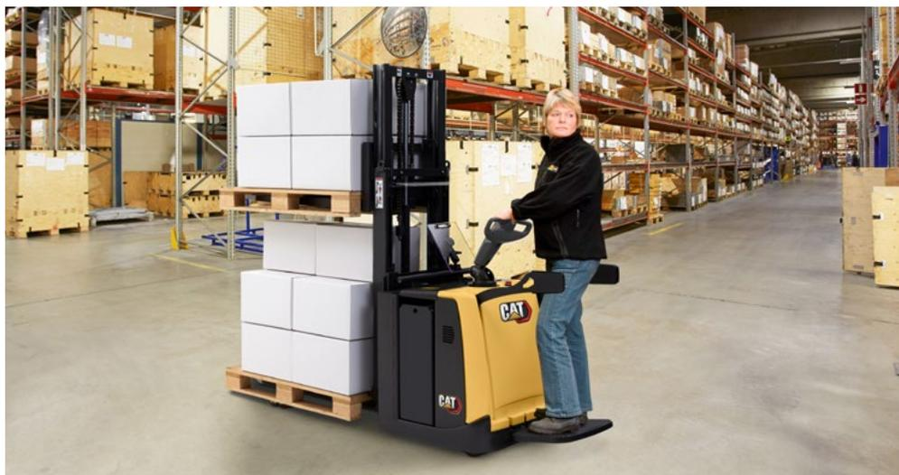
Il transpallet elettrico per doppio pallet, con pedana ribaltabile, NPV20PD fa risparmiare tempo trasportando due pallet contemporaneamente (uno sopra l'altro). È perfetto per il doppio accatastamento sulle rampe di carico e per il trasporto di carichi in entrata e in uscita su brevi, medie o lunghe distanze.
