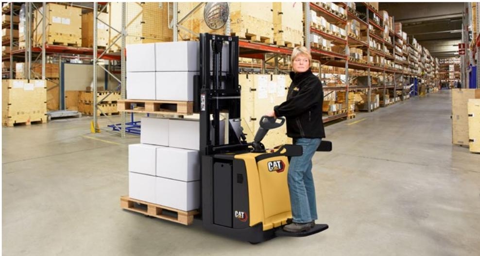
Der NPV20PD Doppel-Palettenhubwagen mit abklappbarer Plattform spart Zeit, indem er zwei Paletten gleichzeitig befördert (eine über der anderen). Er eignet sich perfekt für doppeltes Stapeln auf der Laderampe und für den Transport eintreffender oder abgehender Waren über kurze, mittlere oder lange Distanzen.
