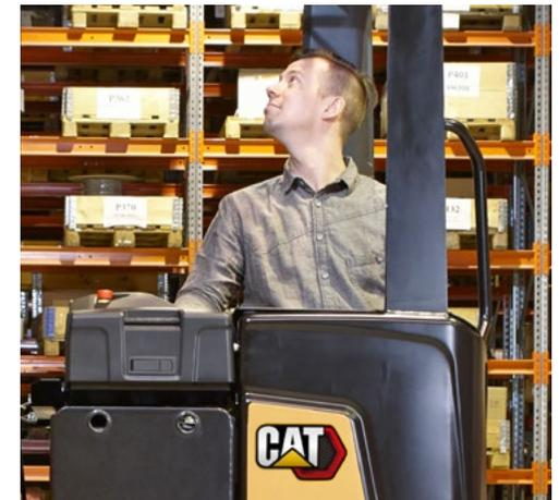
Die Fahrgeschwindigkeit wird in Kurven oder beim Heben der Gabeln automatisch und stufenlos geregelt, um Gefahren zu vermeiden. Zu den weiteren Schutzmaßnahmen gehört die stufenlose Verlangsamung der Lenkreaktion mit zunehmender Fahrgeschwindigkeit, um beim Manövrieren sichere Kontrolle zu behalten.
