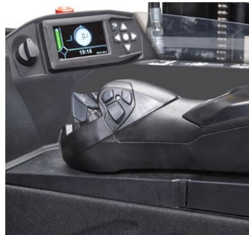
Die moderne Fingertip-Hydrauliksteuerung ist in eine ergonomische, verstellbare Armlehne integriert. Höhe und Winkel des Lenkrads sind verstellbar, und der Fahrer kann mit verschiedenen Handhaltungen lenken. Ein Multifunktionsdisplay mit Anzeigen in leuchtenden Farben liefert nützliche Informationen.
