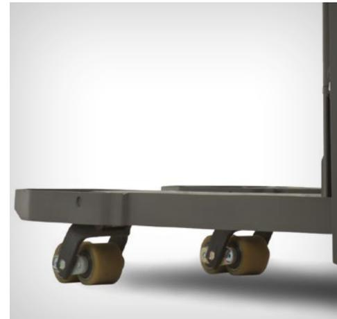
Das Initialhub-Modell NSV16PI kann die Radarme heben, um für die Fahrt auf unebenen Böden und Rampen zusätzliche Bodenfreiheit zu schaffen. Es kann außerdem zwei Paletten gleichzeitig transportieren, eine auf den Radarmen und eine auf den Gabeln.
