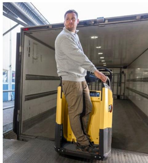
Les versions à plate-forme fixe avec entrée par l'arrière NPF20N3R et NPF25N3R sont parfaitement adaptées aux opérations de chargement et de déchargement. Par sécurité, elles comprennent en option le ralentissement et l'arrêt automatiques, au cas où le pied de l'opérateur serait hors de la plate-forme.
