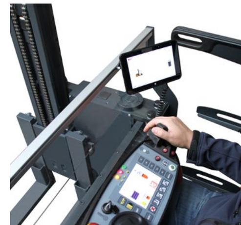
Les sept modèles de la gamme NVT proposent des hauteurs de levée pouvant atteindre 19 mètres\*, et des capacités de levage entre 1,1 et 2,0 tonnes. Grâce à leur modularité, les divers modèles peuvent s'adapter presque indéfiniment aux exigences spécifiques de vos locaux et de l'application.
