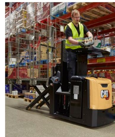
Basés sur la technologie RDS (Responsive Drive System) mise en œuvre pour la première fois sur les récents chariots à contrepoids électriques Cat, les préparateurs de commandes réagissent rapidement aux commandes de direction du cariste et à la vitesse de translation.
