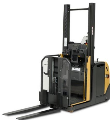
Doté de la plus faible hauteur de marchepied du marché, ce préparateur vous fait gagner du temps et réduit les efforts. L'accès rapide et simple, sans obstacle, est assorti d'un capteur de présence qui recouvre la totalité de la plate-forme, laquelle est protégée par un tapis matelassé antidérapant.
