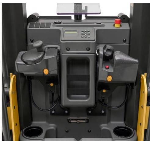
Sur l'interface utilisateur innovante, le cariste pilote l'unité de commande de la main droite. Sa position réglable assure ainsi un confort anatomique idéal. Outre un contrôle précis des fonctions du chariot, cette interface assure un soutien ferme et confortable de la main droite, laissant la gauche actionner le volant Midi.
