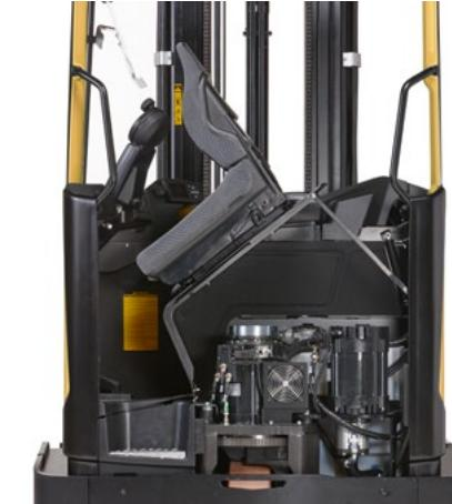
Izdržljiva konstrukcija, dugi servisni intervali i lak pristup komponentama smanjuju zastoj i popravke. Vrhunski zaslon u boji s jednostavnim funkcijama potiče na pažljivu upotrebu i održavanje stroja. Opcijske litij-ionske baterije pridonose dodatnoj energetskoj učinkovitosti i praktički ne zahtijevaju održavanje.
