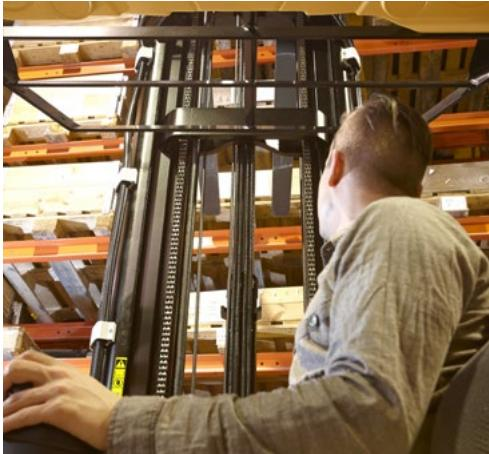
Zahvaljujući hidrauličnim cilindrima ugrađenim u profil, stup powerRamic je snažniji, uži i pruža bolju vidljivost od klasičnog dizajna. Zahvaljujući sustavu odziva pogona (RDS), sva se kretanja stroja i sklopa stupa kontroliraju na glatki i precizni način.
