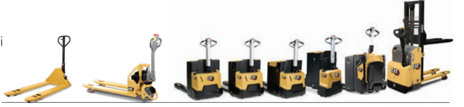
Akülü Palet Taşıyıcı yelpazesi: 1,2 - 2,5 ton kapasite
