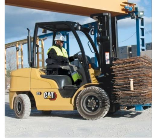
Geniş bir özellikler dizisi Cat forkliftinizin teknik özelliklerini uygulamanıza eşleştirmenizi sağlar. Çimento veya tuğla fabrikaları gibi tozlu uygulamalarda motora artırılmış koruma sağlamak için yüksek kaliteli bir filtre takılıdır. Ya da liman merkezli veya hareketli kullanım için forkliftin bir geminin güvertesine veya bir kamyonun üzerine konulmasını sağlamak için isteğe bağlı kaldırma gözleri takılabilir.
