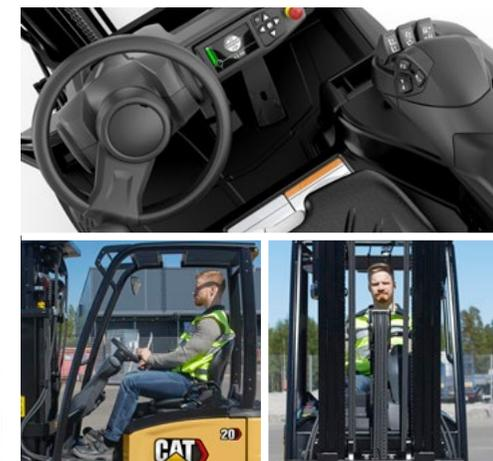
Tillval för styrning i 360° ger större smidighet vid kurvtagning. Med den här funktionen kan trucken svänga och köra i motsatt riktning (180°) utan att behöva stanna, så att inte lasten hamnar i obalans (3 hjul).
