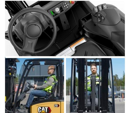
**Sitz und Lenksäule sind verstellbar und gewährleisten eine perfekte Fahrposition für Fahrer jeder Größe. Die Sicht nach vorne, nach unten und zu den Seiten ist hervorragend, dank einer speziell entwickelten Freihubzylinderkonstruktion, bei der Schläuche und Ketten so angeordnet sind, dass Sichthindernisse minimiert werden. Zu den ergonomischen Bedienelementen gehören eine verstellbare Armlehne mit integrierten Fingertip-Hebeln, sowie Pedale, die geringe Ermüdung gewährleisten.**
