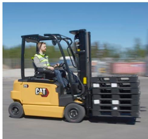
Le système RDS (Responsive Drive System) réagit instantanément aux variations de vitesse du pied et du mouvement de la pédale, ce qui permet de contrôler toutes les actions en douceur, y compris le comportement dans les virages, les arrêts et les démarrages.
