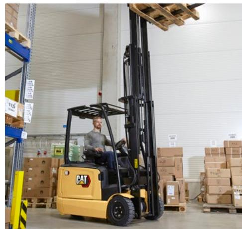
Le système hydraulique à détection de charge s'adapte automatiquement au poids manipulé, pour maintenir un contrôle précis. Le contrôle passif du balancement maintient le frein de stationnement automatique ouvert afin que l'énergie de balancement du mât soit absorbée par la masse du chariot entier. Tous les mâts et déplacements latéraux à faible friction réduisent le balancement, la torsion et le bruit.
