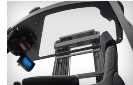
İsteğe bağlı şeffaf baş üstü koruyucu tavan
