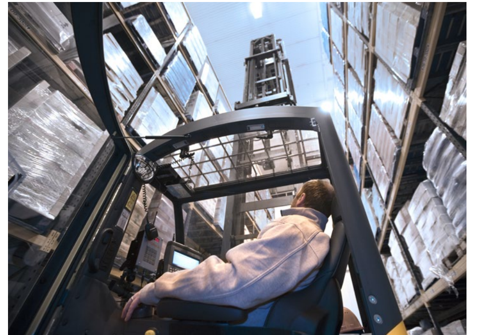
Koruyucu metal ağa sahip şeffaf baş üstü koruyucu tavan ile donatılmış isteğe bağlı kabin.
