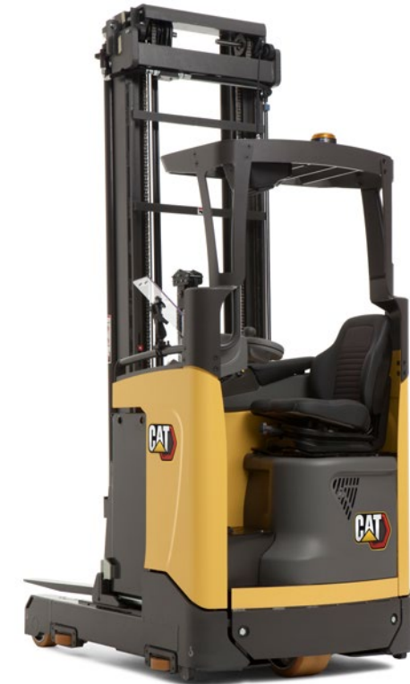
NR14N3C visas med tillvalen avsmalnande skyddstak och skenstyrning.
