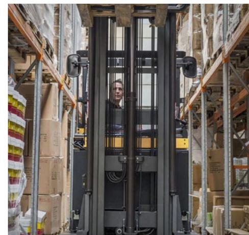
Ya no hay necesidad de utilizar carretillas alimentadoras ni estaciones de recogida y depósito en los extremos de los pasillos, ya que nuestros modelos VNA hombre abajo se encargan del transporte, así como del apilamiento y la recogida. Esto a su vez permite ahorrar en el tamaño de flota, en número de conductores y en tiempo, además de aumentar el espacio de almacenamiento.
