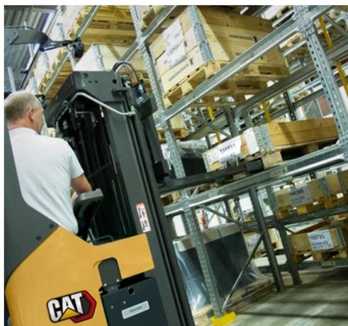
Aunque está especializada en sistemas de apilado de doble profundidad, la carretilla tiene muchos otros usos. Por ejemplo, puede utilizarse para manipular cargas largas o acceder a las zonas de carga de camiones. Puede funcionar como carretilla retráctil, apilador con cuatro patas de apoyo, transpaleta y recogepedidos.
