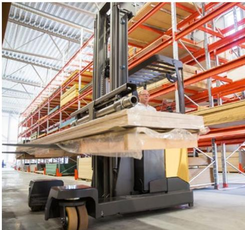
Los conductores pueden manejar tanto cargas de palés normales como artículos extremadamente largos, gracias a un amplio separador de horquillas hidráulico. Esto se combina con rápidos cambios de dirección y movimientos en cuatro direcciones –hacia adelante, hacia atrás, hacia la izquierda y hacia la derecha– lo que permite maniobras rápidas, incluso en pasillos estrechos.
