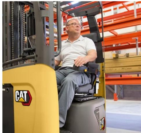
El manejo es relajado pero preciso gracias al joystick multifuncional y a las unidades de control *Palm Steering*. Las posiciones de los reposabrazos y la altura del suelo son ajustables para que el conductor se adapte perfectamente, mientras que la fatiga que supone ver las cargas en altura se reduce gracias a un asiento inclinado y ajustado al peso.
