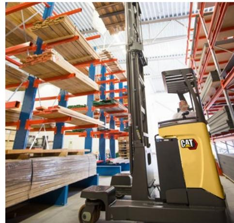
El rendimiento rápido, suave y seguro se garantiza mediante el ajuste automático de la velocidad de conducción y del sistema hidráulico siempre que es necesario, en función del ángulo de dirección, altura de elevación y peso de la carga. El control de la inclinación del mástil, que mejora la estabilidad, se incluye de serie o de forma opcional en función del mástil elegido.
