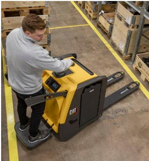
Existen modelos con plataforma fija o plegable, capacidad de carga de 2 o 2,5 toneladas y tres longitudes de chasis para elegir. También pueden equiparse para utilizar batería de iones de litio o de plomo-ácido. Las versiones con plataforma plegable NPV20N3 y NPV25N3 están provistas de barras laterales de protección abatibles.
