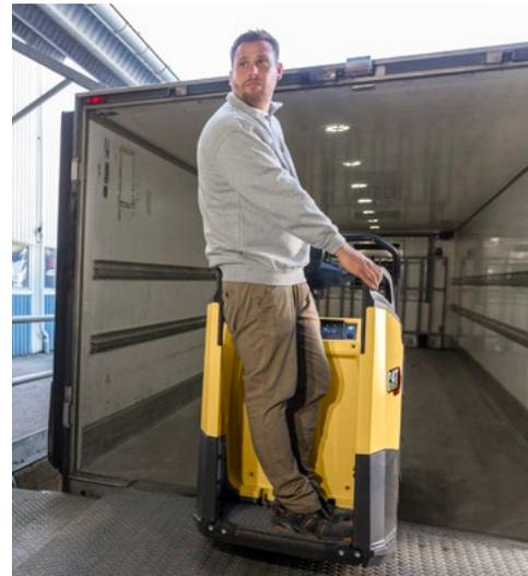
Las versiones con plataforma fija de entrada trasera NPF20N3R y NPF25N3R son perfectas para operaciones de carga y descarga. Como opción, incluyen reducción/parada automática para mejorar la seguridad cuando el operador tiene el pie fuera de la plataforma.
