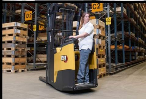
Las horquillas con la parte inferior estrecha y la punta puntiaguda evitan que se atasquen, y facilitan y agilizan la entrada/salida de palets incluso al girar.
