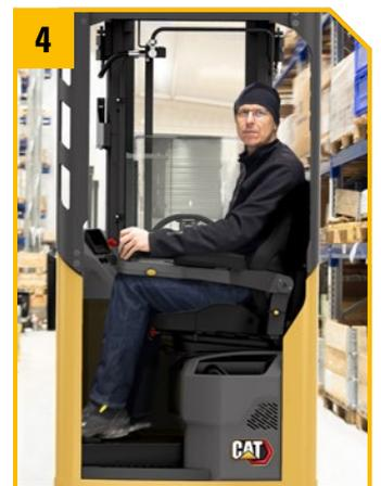
**Especificación de bajo nivel de ruido** gracias a ventiladores silenciosos con control de temperatura y motores de bombas de elevación de velocidad regulada, que crean un entorno agradable para el operario.
