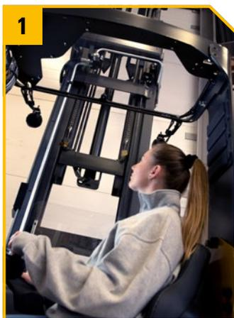
**Gran visibilidad** gracias al diseño del mástil, el portahorquillas, el tejadillo protector y el pilar, que ofrecen una excelente visibilidad en todas las direcciones, hacia delante y de la punta de las horquillas.
