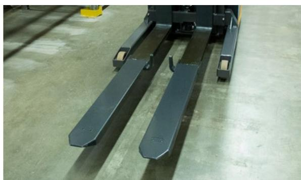
La estructura de las patas de apoyo mejora la entrada y la distancia al suelo, así como el rendimiento en pendientes. Además de su perfil bajo, tienen un ángulo ligeramente inclinado hacia abajo hacia su punto final. Cada una tiene una sola rueda o, como opción, un par de ruedas en tándem, para un movimiento suave.
