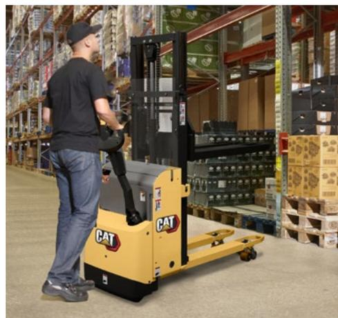
Сопровождаемый перевозчик NPP16PD для двух палет повышает скорость выполнения операций, перевозя две палеты - одну над другой - одновременно. Это удачное решение для погрузочной зоны, подбора заказов и пополнения запасов на производстве, небольших складах и в супермаркетах.
