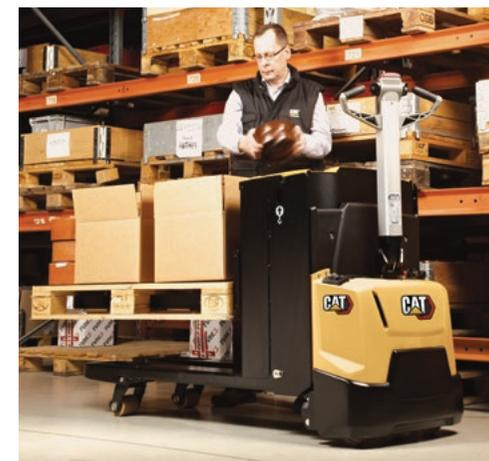
Модель NPP20N2E имеет дополнительный подъём вилок на высоту до 735мм, что обеспечивает эргономичное положение и снижает физическое напряжение при погрузке штучных грузов.
