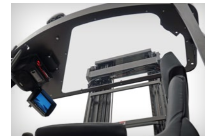
Plafon transparent opțional pe cadrul de protecție.
