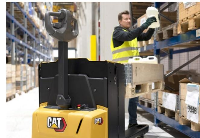
O NPP20N3E está equipado com garfos de elevação (735 mm de altura) que oferecem uma posição ergonómica para carga e descarga de artigos com o mínimo esforço físico.
