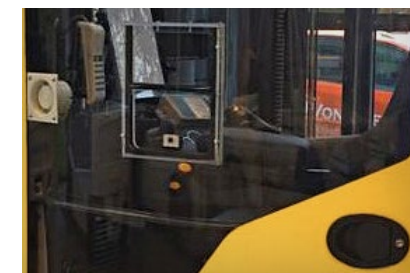
Intercomunicador bidirecional opcional e janela de abertura para cabina aquecida
