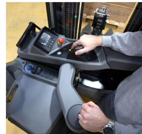
**Os controlos ergonómicos proporcionam mais conforto, satisfação no trabalho e produtividade, evitando ainda o stress, a tensão e a fadiga. Incluem uma consola de direção totalmente ajustável (subida/descida, avanço/recuo), permitindo a posição perfeita do condutor e funções montadas no apoio de braço para controlo simultâneo das funções de tração e hidráulicas.**
