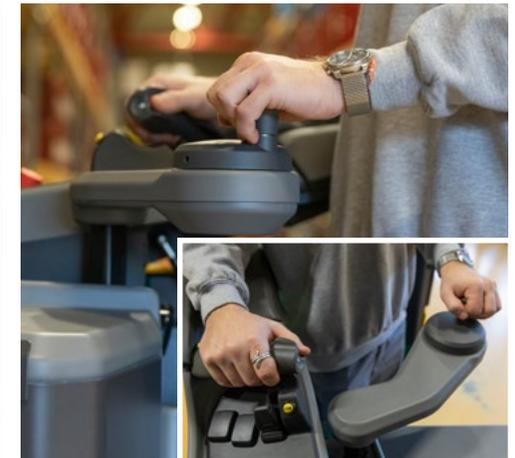
O conforto, a satisfação no trabalho e a produtividade são melhorados ainda mais por controlos ergonómicos que reduzem o stresse, a tensão e a fadiga. Estes incluem uma consola de direção totalmente ajustável (subida/descida, avanço/recuo), permitindo a posição perfeita do condutor e funções montadas no apoio de braço para controlo simultâneo das funções de tração e hidráulicas.
