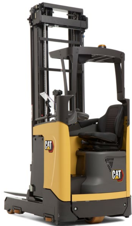
Przedstawiono model NR14N3C wyposażony dodatkowo w stożkową osłonę górną i prowadzenie szynowe.
