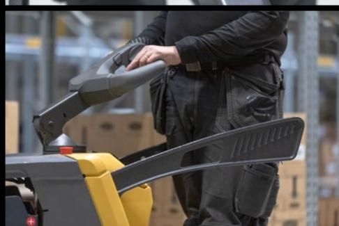
As barras laterais de proteção opcionais nos modelos com plataforma dobrável podem ser instaladas de forma rápida e simples, com apenas uma mão.
