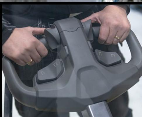
O operador fica ligado a um chassis compacto e estável, através da ergonômica cabeça de timão *emPower* líder na classe.
