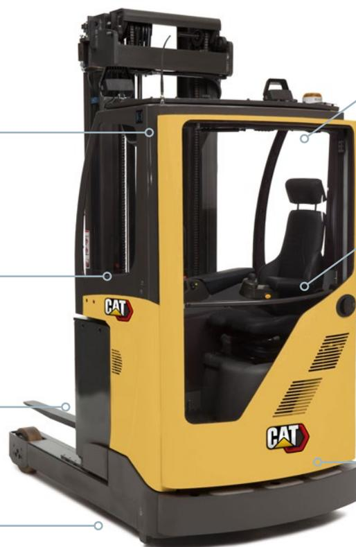
Quando equipado com a cabina e com a modificação para armazenamento frigorífico (MODCS), um empilhador pode funcionar de forma fiável em temperaturas de congelação tão baixas quanto -35°C.
