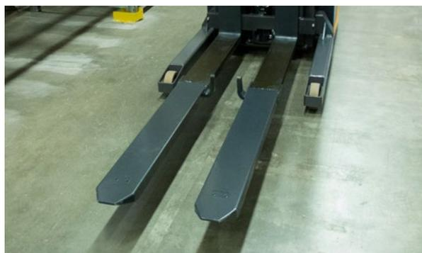
A capacidade drive-in e a distância ao solo, bem como o desempenho de inclinação são melhorados pela estrutura das pernas de suporte. Para além do seu baixo perfil, elas têm um ângulo ligeiramente descendente em direção à sua extremidade. Cada uma tem uma roda ou – opcionalmente – um par de rodas em linha, para um movimento suave.
