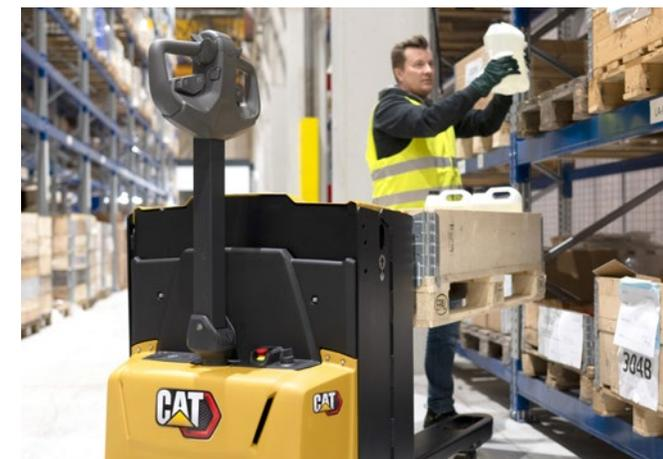
L'**NPP20N3E** è equipaggiato con forche di sollevamento (altezza 735 mm) che permettono una posizione ergonomica che richiede uno sforzo fisico minimo durante il caricamento e scaricamento delle merci.
