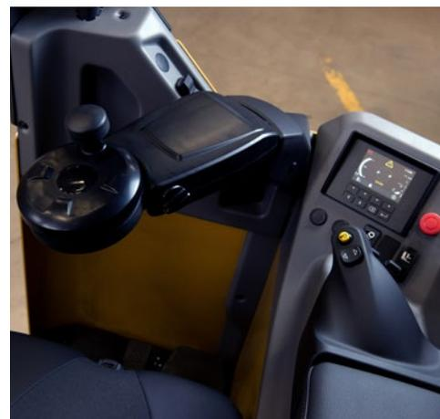
**I comandi facili da usare includono le leve idrauliche a sfioramento, con un bracciolo registrabile e un mini-volante regolabile in posizione. La facilità e la precisione di manovra e di movimentazione del carico da parte del carrello sono ideali per una varietà di compiti e applicazioni che comprendono il lavoro generale di magazzino e il flusso di materiali nelle fabbriche.**
