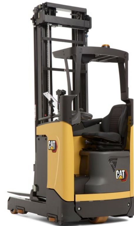
NR14N3C raffigurato con tettuccio di protezione arrotondato e guida meccanica opzionali.
