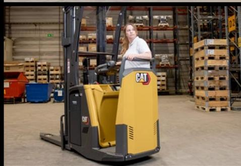
I modelli a pedana fissa offrono maggiore protezione e comfort, con un'altezza del gradino ridotta, per facilitare entrate e uscite, e una scelta di design di barriere per l'ingresso posteriore e laterale.
