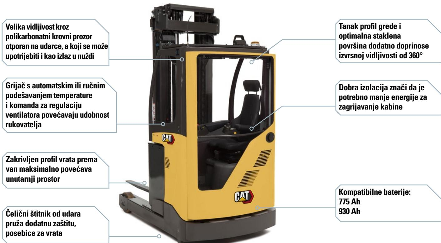
Ako je opremljen s kabinom i potrebnim preinakama za hladnjaku (MODCS), viličar može pouzdano raditi i pri vrlo niskim temperaturama do čak -35°C.
