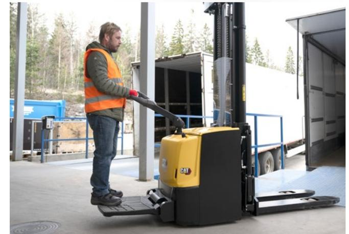
Modelle mit einer kleinen abklappbaren Plattform sind mit 1,0, 1,2, 1,4 und 1,6 Tonnen Tragkraft erhältlich und machen bei längeren Distanzen die Beinarbeit überflüssig.
