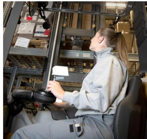
Das Bedienpersonal sitzt sicher in einer ruhigen, vibrationsarmen und ergonomisch ausgestatteten Kabine. Vollständig von der robusten Konstruktion des Staplers umschlossen und geschützt kann es Stunde um Stunde schneller und sicherer arbeiten. Stress, Belastung und Ermüdung werden auf ein Minimum reduziert. Zusätzliche verfügbare Komfortoptionen erlauben zum Beispiel die elektrische Einstellung der Bodenfläche.
