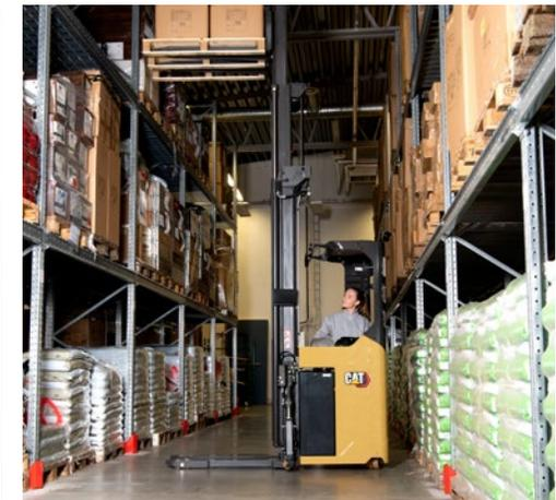
Hochentwickelte Antriebs- Hub- und Lenksysteme erlauben die schnelle und reibungslose Ausführung jeder Bewegung. Automatisierte Stabilitätskontrollen wählen die optimale Geschwindigkeit für die jeweilige Tätigkeit, sodass stets der sichere, aber zügige Betrieb gewährleistet ist. Für ununterbrochene Verfügbarkeit und höchste Effizienz können Sie Lithium-Ionen-Akkus wählen.
