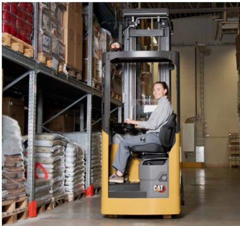
Sitz-Niederhubwagen sind schneller und kompakter als Plattformhubwagen und das Ein- und Ausklappen von Plattform und Seitenschutzbügeln entfällt. Sie können sich bei der Hubhöhe mit so manchem Schubmaststapler messen, sind dabei aber kostengünstiger und kompakter. Warum also Gänge nicht schmaler anlegen, Regale erhöhen und Ihre Lagerflächen noch effizienter nutzen?
