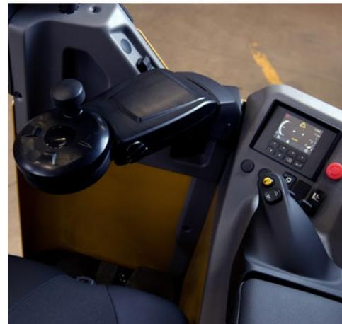
Zu den benutzerfreundlichen Bedienelementen gehören Fingertip-Hydraulikhebel mit verstellbaren Armlehnen sowie ein verstellbares Mini-Lenkrad. Durch das einfache und präzise Handling von Fahrzeug und Last eignet sich der Stapler für verschiedenste Anwendungen und Einsatzgebiete. Dazu zählen allgemeine Lageranwendungen ebenso wie der Materialtransport in Fabriken.
