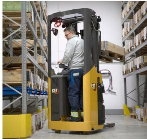
Die Stapler mit Fahrerstandplatz ermöglichen Ihnen eine umfassendere Ausnutzung Ihres wertvollen Lagerraumes, indem Sie die Gänge verengen und die Regale erhöhen. Sie erfüllen mehrere Aufgaben, einschließlich der Kommissionierung, und bieten ähnliche Hebekapazitäten wie viele Schubmaststapler, jedoch zu niedrigeren Preisen und in engeren Räumen.
