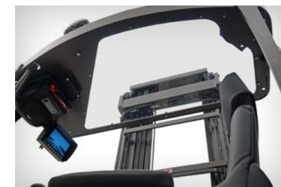
Optionales transparentes Fahrerschutzdach.
